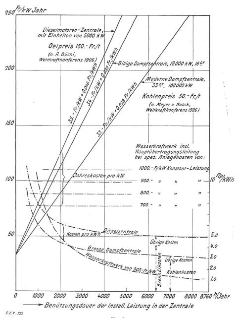
Fig. 3. Vergleich der Jahreskosten von Wasser- und Wärmekraftwerken.
