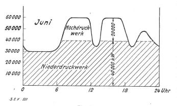
Fig. 2. Tages-Leistungsdiagramme, Beispiel B. (Kombination zwischen Nieder- und Hochdruckwerk.)
