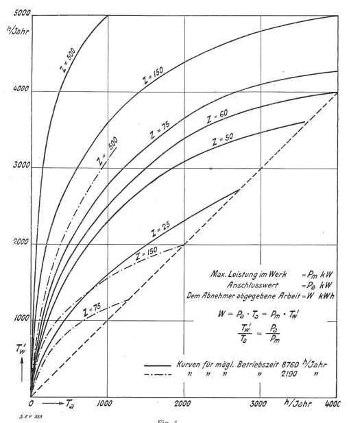
Fig. 4. Kurven der Benützungsdauer  $T_{\mathbf{w}}$  im Werk in Abhängigkeit von Benützungsdauer  $T_{\mathbf{a}}$  der Anschlüsse (nach Prof. Kummer).
