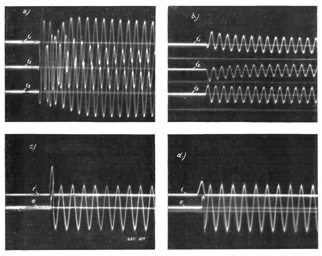
Kurzschluss eines Generators von 2700 kVA Leistung, 6000 Volt, 50 Perioden.
