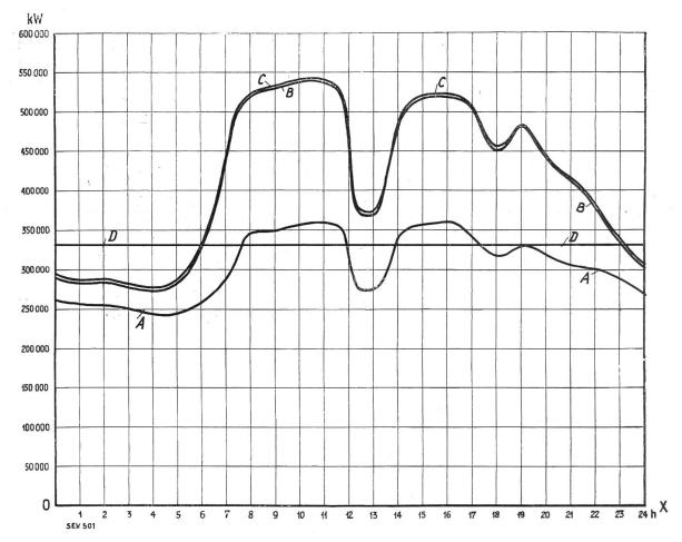
Leistung der Flusskraftwerke . . . . . . . . . . . . . . .  $= OX \cdot A = Pu$ issance utilisée dans les usines au fil de l'eau. Leistung der Saisonspeicherwerke . . . . . . . .  $= A \cdot B = Pu$ issance utilisée dans les usines à réservoir saisonnier. Leistung der kalorischen Anlagen und Energieeinfuhr . .  $= B \cdot C = Pu$ issance produite par les installations thermiques et importée.
