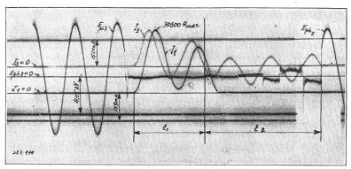
Fig. 8. Begünstigung des Abschaltvorganges durch asymmetrischen Stromverlauf. Abschaltung eines dreiphasigen Kurzschlusses bei 8,5 kV. Die Löschung des Stromes  $I_1$  erfolgt bei ersterem um  $90^{\circ}$  phasenverschobenen Nulldurchgang nach 0,04 sec. Die beiden andern Phasen brennen nachher noch während 0,055 sec.:  $t_1 = 0,034$  sec.,  $t_2 = 0,06$  sec.
