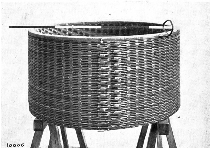
Fig. 7. Zum Einbau bereites Spulenpaket der Mittelspannungswicklung. Gewicht ca. 700 kg. Aeusserer Durchmesser ca. 1600 mm.
