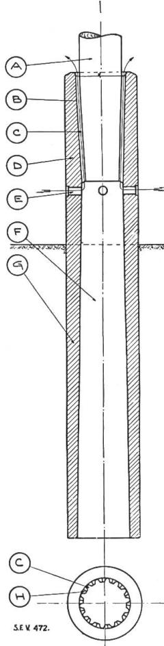
Eine Variante zu den schonbekannten Sockeln für Holzmaстen bildet der Mebefuss aus armiertem Beton, der in Schweden verwendet wird. Die nebenstehende Skizze zeigt die Anordnung, wonach das Ende der Holzstange vor Fäulnis geschützt werden soll. Die Länge des Fusses beträgt, je nach Type, 2 bis 2,54 m und dessen Gewicht 185 bis 340 kg.
