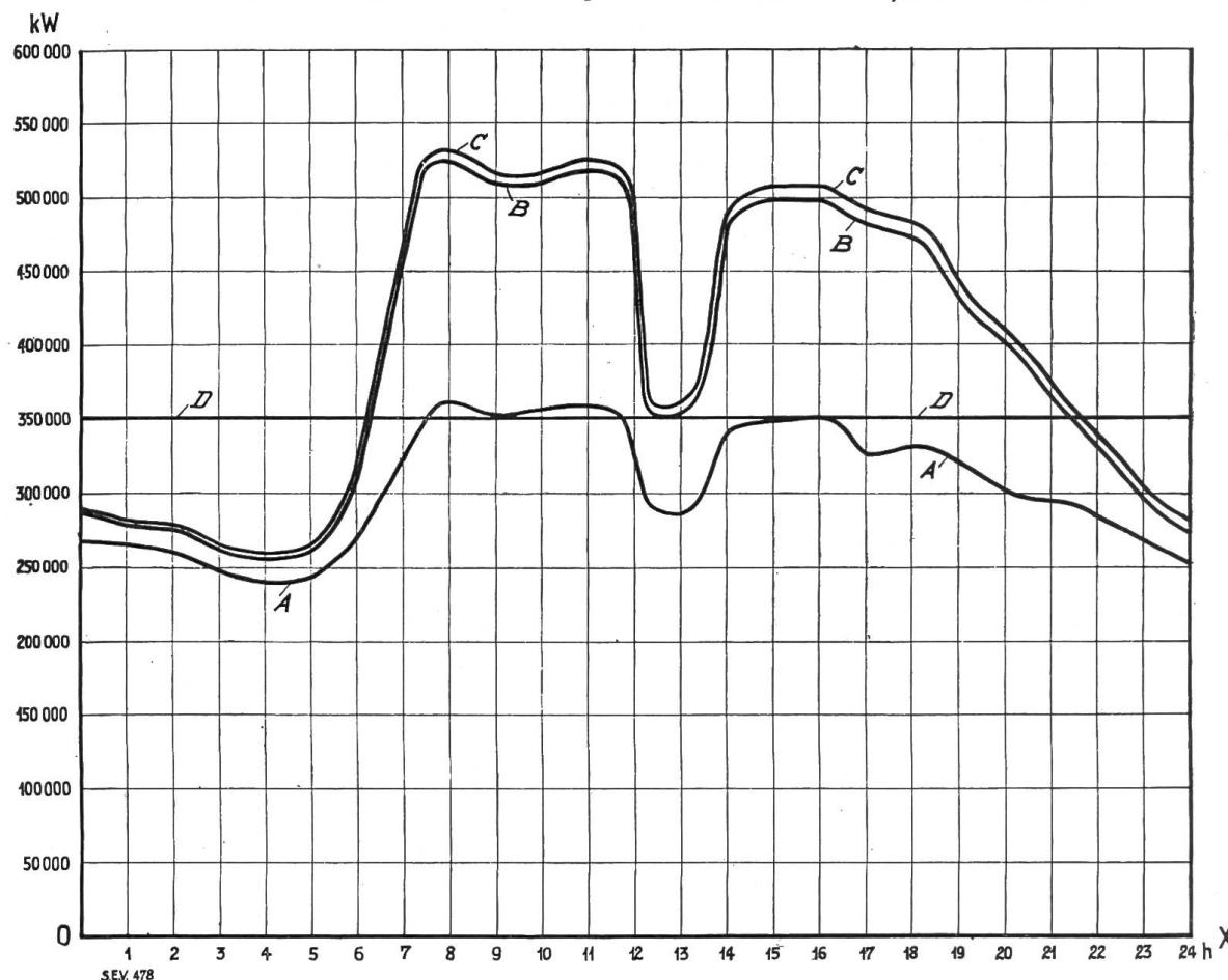
Leistung der Flusskraftwerke . . . . . =  $O \cdot X \div A$  = Puissance utilisée dans les usines au fil de l'eau.
