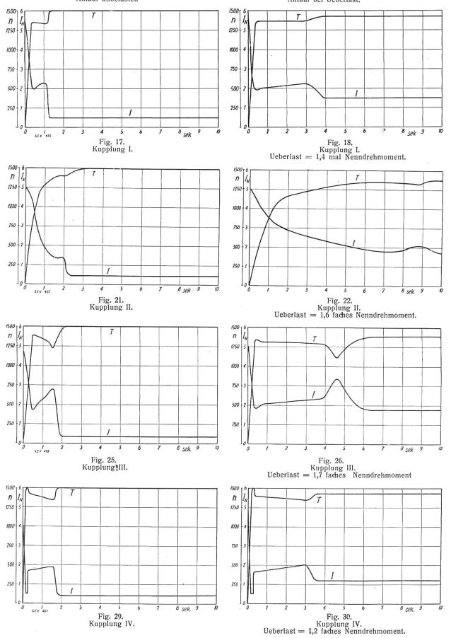
Zu weiterem Vergleich ist in Fig. 31 bis 34 der Anlauf des Motors dargestellt, wenn die Kupplung K (Fig. 14) durch eine feste Riemenscheibe ersetzt wird. Es ist dabei zu beachten, dass das Lastmoment nur das 1,3 fache des Nenndrehmomentes betrug, da sonst ein Anlaufen des Motors nicht hätte erzielt werden können.
