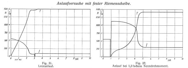
Zeitlicher Verlauf des Statorstromes (I) und der Rotortourenzahl (T) bei Einschalten mittels Stern-Dreieck-Schalter.
