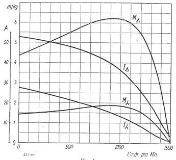
Fig. 1. Drehmoment  $(M_{\Delta} \text{ und } M_{\Delta})$  und Statorstrom  $(I_{\Delta} \text{ und } I_{\Delta})$  eines Käfiganker-Motors in Funktion der Tourenzahl.
