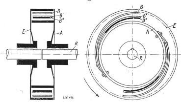
Fig. 10. Schematische Darstellung der Kupplung I. Rotorwelle A: Antreibender Teil
