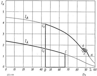
Fig. 7 a (oben) und 7 b (unten). Anlaufvorgang bei reinen Fliehkraft-Kupplungen in Funktion der Tourenzahl.
