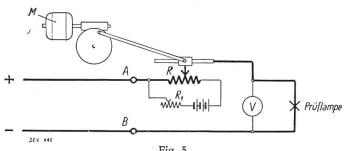
Fig. 5. Versuchsanordnung zur Erzeugung von nach Grösse und Frequenz regulierbaren Schwankungen des Glühlampenlichtes. (M=Antriebsmotor, R=Gleitwiderstand,  $R_1$ =Regulierwiderstand.)
