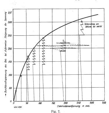
Schlagweite in kaltem Oel mit "Di-El" Stäben als Isolierdistanz. Metallfassung Elektrode c mit r=15 mm Abrundung. Bei den Zickzacklinien in der Figur bedeutet ein horizontaler Strich von 2 mm eine Rast von  $^{1}/_{2}$  Minute in der Steigerung der Prüfspannung. Die metallischen Fassungen sind von der Staboberfläche durch einen isolierenden "Di-El" Ring um 5 mm radial distanziert.
