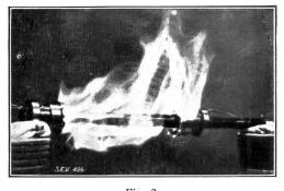
Fig. 3. "Di-El" Stab. Distanz = 245 mm; Ueberschlag bei 150 kV.
