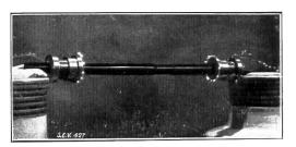
"Di-El" Stab mit 345 mm Distanz bei 185 kV (= 90%0 der Ueberschlagsspannung).
