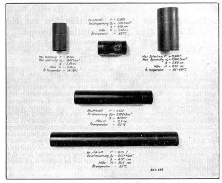
Fig. 10. Druckproben von "Di-El" Stäben.
