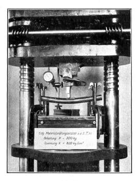
Fig. 11. Biegeproben mit "Di-El" Stäben.
