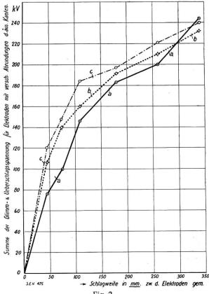
Fig. 2. Summe der Glimm- und Ueberschlagsspannung für "Di-El" Stäbe bei verschiedener Kantenrundung der Elektroden.
