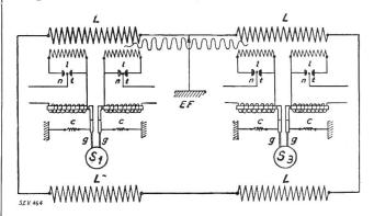
Abbildung\* zeigt die schematische Darstellung einer Ringleitung nach einer Anordnung der Emag in Frankfurt a. M. An den beiden Enden der Riegeldrosselspulen L liegen die Induktionsspulen l, deren offene Enden bei Wirksamkeit an den Kontaktstellen n—t einen Funken ent-
