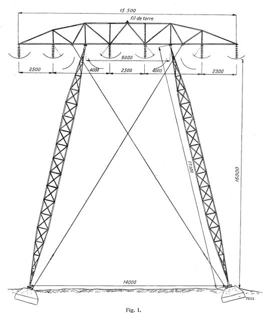
Pylône-chevalet [articulé Darrieus pour ligne triphasée double à 120 kV (six conducteurs en nappe horizontale).
