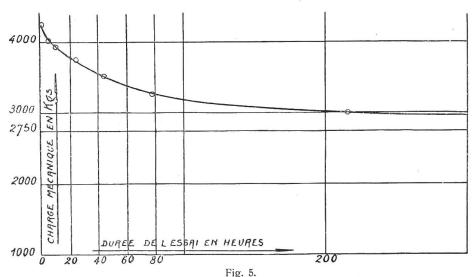
Durée d'un isolateur du modèle 9985 de la "Compagnie Générale d'électro-céramique" en fonction de la charge mécanique, pour une tension électrique de 50 kV.
