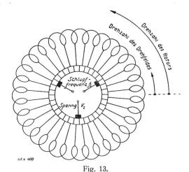
Erzeugung von kapazitiver Blindleistung im rascher als das Drehfeld rotierenden Kellektoranker.
