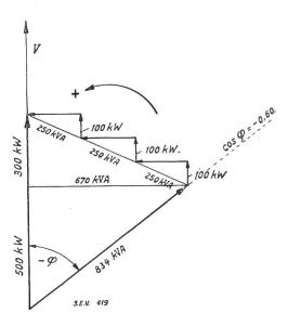
Fig. 24. Gruppenverbesserung des Leistungsfaktors vom 100 Kleinmotoren von 0,6 auf 1,0 durch 3 grössere Motoren.
