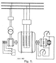
Schaltung eines gewöhnlichen Synchronmotors mit Gleichstrom-Erregermaschine und Anwurfmotor.
