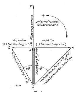
Fig. 1. Leistungsdiagramm einer Wechselstromübertragung.
