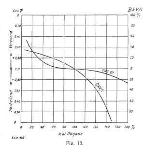
Leistungsfaktor und Blindleistungsaufnahme des Synchronmotors mit Anlaufwicklung.
