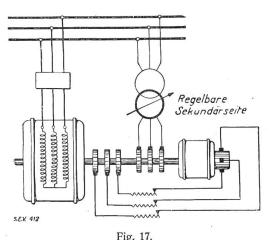
Prinzipielle Schaltung eines Asynchronmotors mit fremderregter Drehstrom-Erregermaschine.
