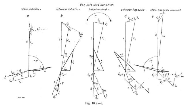
Vektordiagramme mit verschiedenen Phasenverschiebungen  $\pm \varphi_1$  eines Drehstrom-Asynchronmotors mit fremderregter Drehstrom-Erregermaschine.
