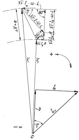
Fig. 4. Vektordiagramm für Strom und Spannung, den Spannungsabfall einer Leitung darstellend.
