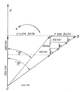
Tig. 23. Gruppenverbesserung des Leistungsfaktors von 100 Kleinmotoren von 0,6 auf 0,77 durch 3 grössere Motoren.
