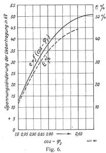
Kurve der Spannungsänderung in Funktion des Leistungsfaktors bei konstanter Vollast.
