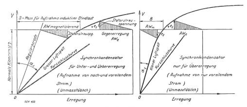
Fig. 8 und 8a. Leerlaufcharakteristiken von Synchronblindleistungsmaschinen.
