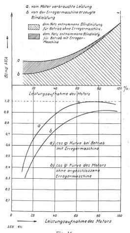
Fig. 16. Leistungsfaktorkorrektur durch eigenerregte Drehstrom-Erregermaschine.
