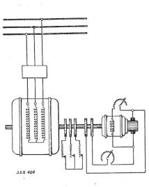
Fig. 9. Schaltung eines selbstanlaufenden Synchronmotors.
