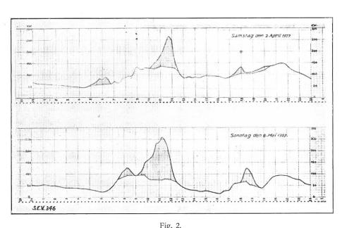
Belastungsdiagramm von Balsthal ohne Industriekraft (schraffierte Fläche = Kochstrom).
