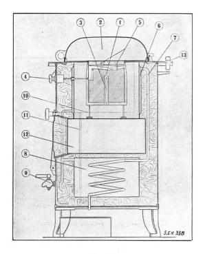
Fig. 16. Schnitt durch den Seves-Speicherherd.
