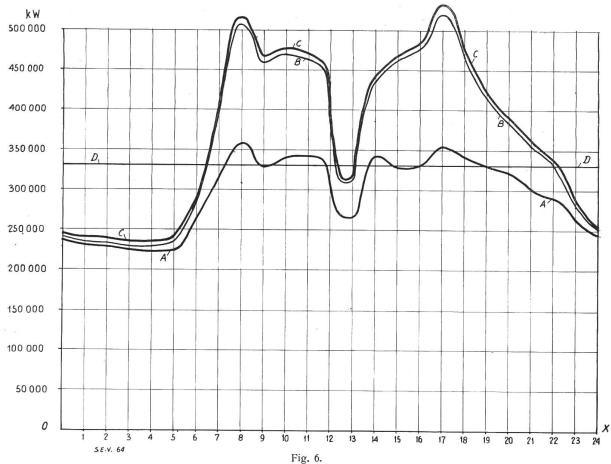
Verlauf der wirklichen Gesamtbelastung am 15. Dezember 1926 der Elektrizitätswerke der Schweiz, welche in eigenen Erzeugungsanlagen über mehr als 1000 kW verfügen, d.h. ca. 94 % der Gesamtproduktion.
