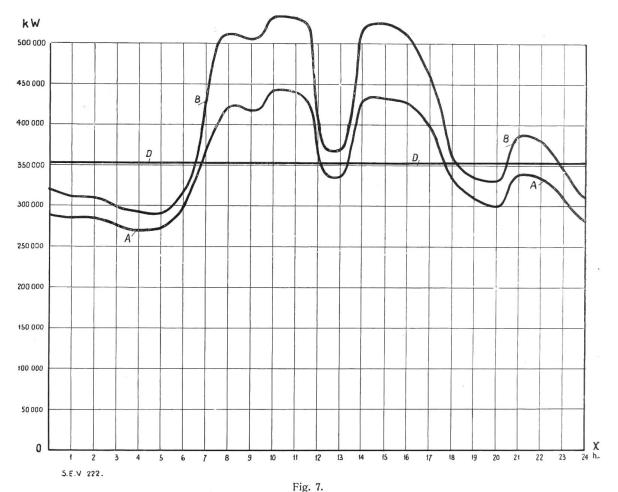
Verlauf der wirklichen Gesamtbelastung am 15. Juni 1927 der Elektrizitätswerke der Schweiz, welche in eigenen Erzeugungsanlagen über mehr als 1000 kW verfügen, d. h. ca. 94% der Gesamtproduktion.
