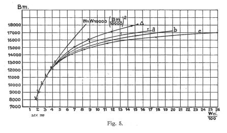
mit einer Potenz der Kraftflusstärke halb des Kernes steigen, die grösser als eins ist, sie werden also auch schneller anwachsen als die Spannungen, welche von diesen Kraftflüssen induziert werden. Verlustkurven müssen also noch stärker ausgesprochenen Sättigungscharakter besitzen als die Kurven der dritten Oberspannungen.
