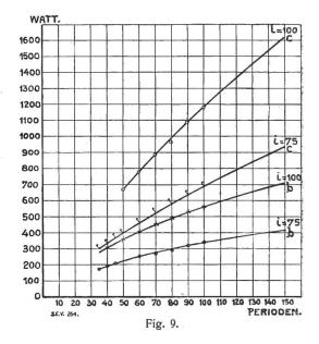
net werden. Berechnet man diesen Verlust aus den Kurvenscharen b und c bei einer bestimmten Stromstärke  $i_3$  und 150 Per./s, so muss der Unterschied zwischen diesen Verlustwerten dem Unterschied zwischen den Leerlaufverlusten des Stern-Stern geschalteten Transformators im Zustand b und c bei der zu  $i_3$  gehörigen reduzierten Induktion gleich sein.
