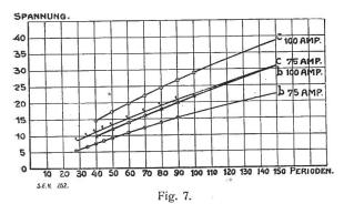
Die Spannungen wachsen sehr viel langsamer als die Frequenz. Bei 100 A ist z. B. die Spannung bei 50 Per./s und Anordnung c: 17 V, bei 150 Per./s ist sie nicht 51 V, sondern nur 38 V. Man würde also für die dritten Oberspannungen viel zu hohe Werte bekommen, wenn man diese Spannungen aus den Messungen bei 50 Per./s proportional der Frequenz umrechnete!
