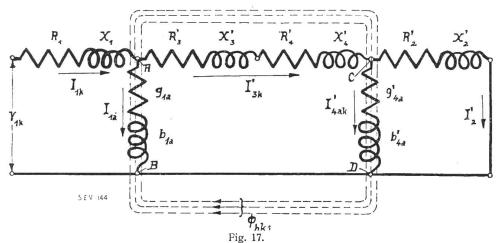
Ersatzschaltung beim Kurzschlusszustand bei Primärspannung.
