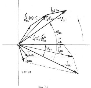
Kurzschlussdiagramm bei sekundärem Vollaststrom des Kaskadentransformators.
