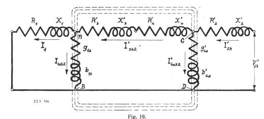
Ersatzschaltung für den Kurzschlusszustand bei sekundärseitiger Speisung.
