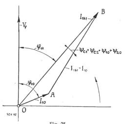
Fig. 25. Kurzschlussdiagramm der Ströme bei kurzgeschlossenen Sekundärklemmen und bei voller Netzspannung.
