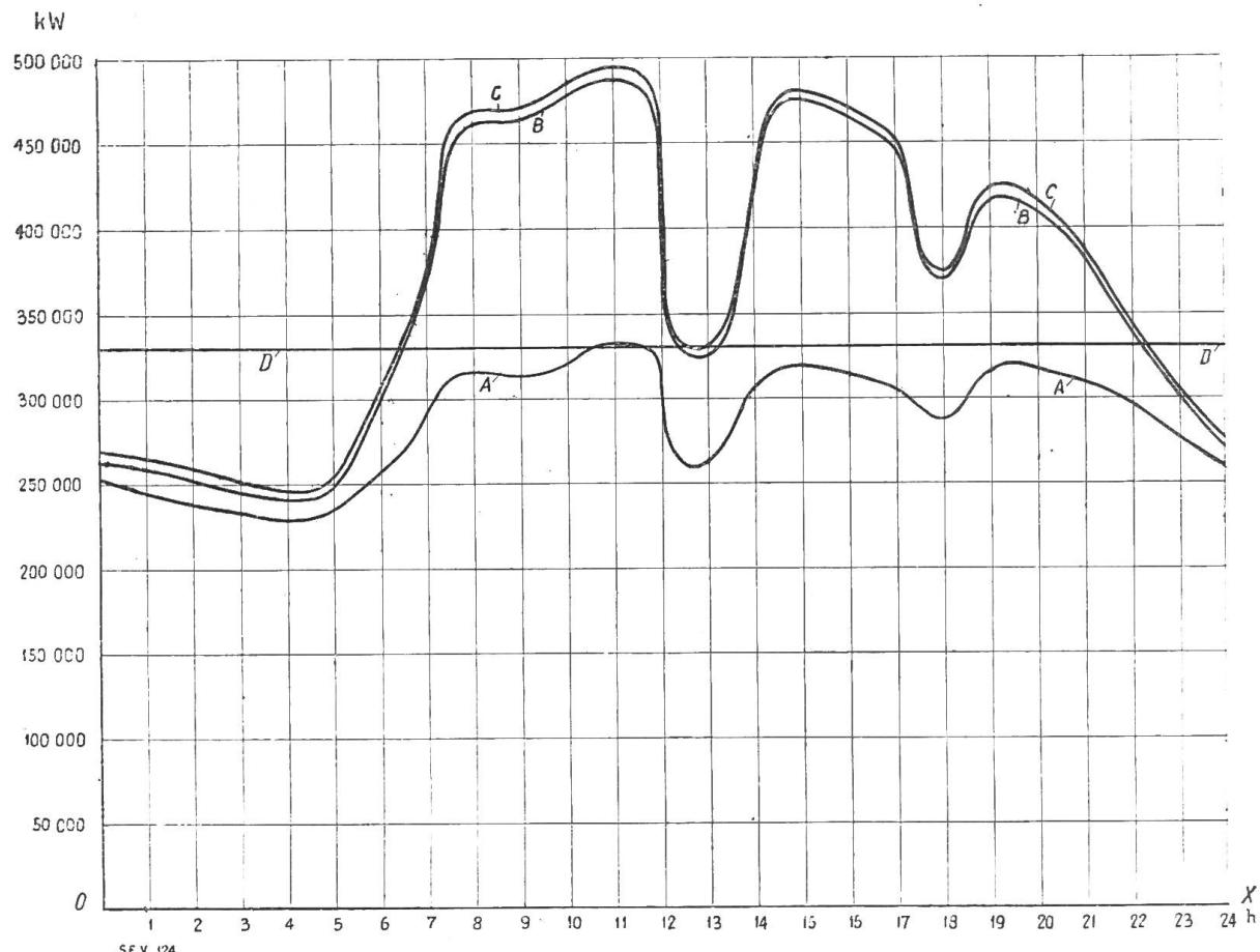
Leistung der Flusskraftwerke . . . . . =  $O \times A$  = Puissance utilisée dans les usines au fil de l'eau
