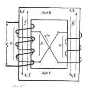
Fig. 5. Wicklungsschema mit entgegengesetzter Felderzeugung,  $w_3 < w_4$  und  $I_{50} < 0$ .
