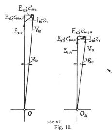
Diagramm der Leerlaufspannungen in der Primärwicklung
