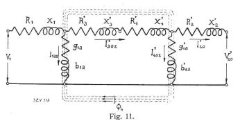
Ersatzschaltung bei Sekundärspeisung im Leerlauf.
