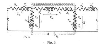
Ersatzschaltung des Kaskadentransformators im Leerlaufzustand.
