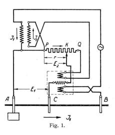
takt K. Wenn das Instrument stromlos ist, müssen  $E_1$  und  $E_2$  entgegengesetzt gleich, also  $E_1+E_2\equiv 0$  sein. Zu gleichen Strömen gehören aber nur dann gleiche Spannungsabfälle, wenn die Widerstände gleich sind, d. h. das abgegriffene Stück auf dem Vergleichswiderstand ist gleich dem gesuchten Widerstand der Erdelektrode. Durch eine einfache Umschaltung des Stromwandlers, nach der  $I_2\equiv 10\,I_1$  ist, wird der Messbereich ohne weiteres im Verhältnis 1:10 erhöht.
