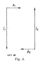
Dass dem so sein muss, sei an Hand des folgenden Beispiels und der Fig. 4 gezeigt. Im Leiter 1 fliesse der Strom  $I_1$ , welcher im Leiter 2 die Spannung  $p_2$  induziere. Umgekehrt induziert der im Leiter 2 fliessende Strom  $I_2$  im Leiter 1 die Spannung  $p_1$ . Die Blindleistungen berechnen sich zu:
