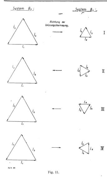
Trennt man die beiden Betriebe, so wird der eine gegenüber dem andern in der Frequenz etwas zurückbleiben. Auf Fig. 11 angewendet, bedeutet dies, dass das eine Dreieck gegenüber dem andern eine Drehung ausführt. Seien  $f_1$  und  $f_2$  die Frequenzen der beiden Netze, so ist die Dauer einer vollständigen Drehung des Vektoren-Dreiecks:
