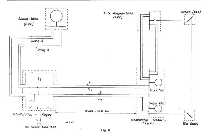
Vier 50 kV-Leitungen führen von den Sammelschienen E.W.Z. nach der Stadt Zürich, wo die Energie in den Unterwerken Frohalp, Albishof, Schlachthof, Guggach und Drahtzug auf 6000 V transformiert, dem Kabelverteilnetz zugeleitet wird.
