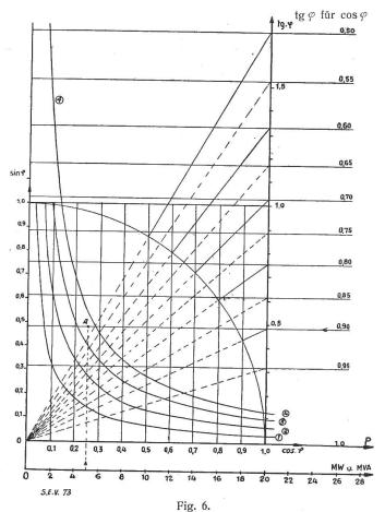
Polares Diagramm zum Ermitteln der für die volle Kompensation notwendigen Anzahl Phasenschieber bestimmter Blindleistung.
