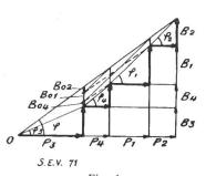
Fig. 4. Verteilung der Blindlastkomponente  $B_0$  auf die Generatoren 1, 2 und 4; Wirklast unverändert,  $\cos \varphi = 0.8$ .  $B_{01} + B_{02} + B_{01} = B_0$ .  $\varphi_1 = \varphi_2 = \varphi_4 > \varphi_3$ .
