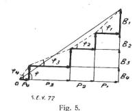
50% Wirklast von Generator 4 auf Generator 2 übertragen; Blindlast-komponenten unverändert.  $\varphi_1 \stackrel{.}{-} \varphi_2 \stackrel{.}{-} \varphi_3 \stackrel{.}{-} \varphi_4$ .
