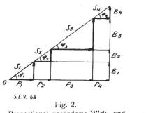
Proportional veränderte Wirk- und Blindlast der 4 Generatoren:  $\cos \varphi = 0.8$ .  $\varphi_1 = \varphi_2 = \varphi_3 = \varphi_4 = \varphi.$
