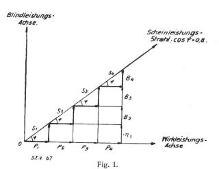
Gleichmässige Verteilung von Wirk- und Blindleistung auf 4 Generatoren für  $\cos \varphi = 0.8$  gezeichnet.
