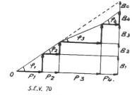
Fig. 3 a. Generator 3 läuft mit verkleinerter Erregung; Blindlastkomponente  $B_0$  ungedeckt;  $\cos \varphi = 0.8$ .
