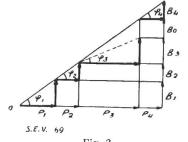
Fig. 3. Generator 3 läuft mit verkleinerter Erregung; Blindlastkomponente mit  $B_0$  undedeckt;  $\cos \hat{\varphi} = 0.8$ .
