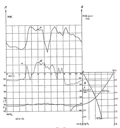
Fig. 12. Tagesdiagramm der Wirk- und Blindlast, sowie des Phasenwinkels am Anfang der Leitung, bei zeitlich abgestufter künstlicher Kompensation (Strecke B tg  $\varphi_2=0,026$ ).
