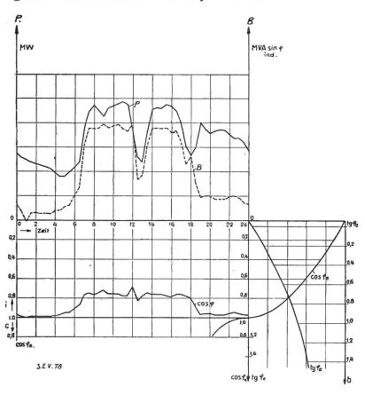
Fig. 11. Tagesdiagramm der Wirk- und Blindlast, sowie des Phasenwinkels am Anfang der Leitung vor Einführung der künstlichen Kompensation (Strecke B tg  $\varphi_2=0,026$ ).
