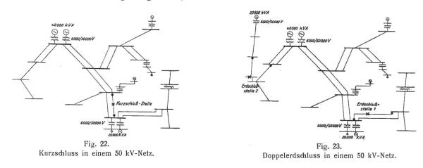
Ein Doppelerdschluss trat im selben Netz, wie Fig. 23 zeigt, auf dem Strang einer von dem kleineren Kraftwerk ausgehenden Doppelleitung und im Sammelschienenraum einer weit entfernten Station ein. Der fehlerhafte Strang wurde beidseitig abgeschaltet, desgleichen die fehlerhafte Station, auf der sich der Doppel-
