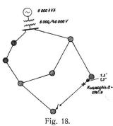
Lichtbogenkurzschluss in einem 40 kV-Netz.
