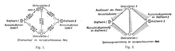
Je mehr man sich der Fehlerstelle nähert, um so mehr nehmen die Auslösezeiten ab. Bei wenig vermaschten Netzen kann jedoch das Prinzip der Stromabhängigkeit allein noch keine befriedigende Lösung der Selektivschutzfrage bieten, während
