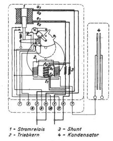
Schematische Darstellung des Impedanz-Relais.
