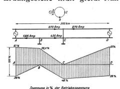
Fig. 10. Strom- und Spannungsverteilung bei Doppelerdschluss in einem Ringnetz.
