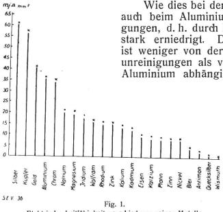
Elektrische Leitfähigkeit verschiedener reiner Metalle bei + 18° C.
