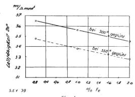
Fig. 4. Abhängigkeit der Leitfähigkeit vom Fe-Gehalt. Si-Gehalt 0,2 $^0$ /0 konstant. Fe-Gehalt von 0,2 $-2^0$ /0 steigend.
