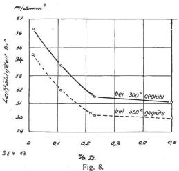
Abhängigkeit der Leitfähigkeit vom Ti-Gehalt. Fe-Gehalt 0,35-0,43 %. Si-Gehalt 0,16-0,18 %. Ti-Gehalt steigend von 0-0,5 %.
