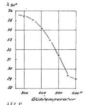
Fig. 6. Leitfähigkeit einer 10/0igen Al-Si-Legierung, in Abhängig-keit von der Wärmebehand-lung. Fe-Gehalt 0,2%.
