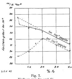
Fig. 7. Einfluss von Fe und Si. Si-Gehalt  $1^{9}/_{0}$  konstant. Fe-Gehalt von  $0.2-4^{9}/_{0}$  steigend.
