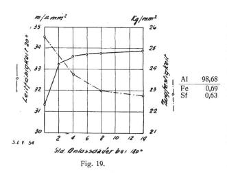
Was bei verschiedenen Aluminiumqualitäten durch eine solche Behandlung erreicht werden kann, geht aus den nachfolgenden in Fig. 13-19 graphisch dargestellten Beispielen hervor. Das mit der betreffenden Aluminiumqualität durch Glühung bei 300° C erreichbare Leitfähigkeitsmaximum ist in den Figuren durch eine gestrichelte Linie eingezeichnet.
