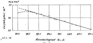
Abhängigkeit der Leitfähigkeit nach Glühung bei 300° C vom Reinheitsgrad des Al.
