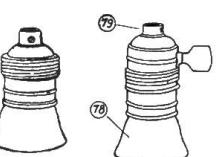
76. Die **Fassung** ist eine Vorrichtung, welche zum leicht lösbar Anschluss von Glühlampen an ihre Zuleitung dient.
