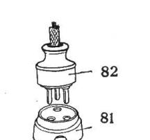
80. Der **Steckkontakt** ist der Apparat, mit welchem eine transportable Leitung mit einer fest verlegten oder beweglichen derart verbunden wird, dass die Kontaktherstellung und -unterbrechung beliebig oft und ohne Lösen von Schrauben geschehen kann. Der Steckkontakt besteht aus Steckdose und Stecker.
