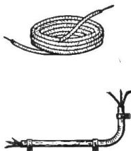
38. Eine Leitung ist die aus Leitern eines Stromsystems und ihren Befestigungs- und Schutzmitteln erstellte Einrichtung, welche zur Uebertragung von elektrischem Strom dient.
