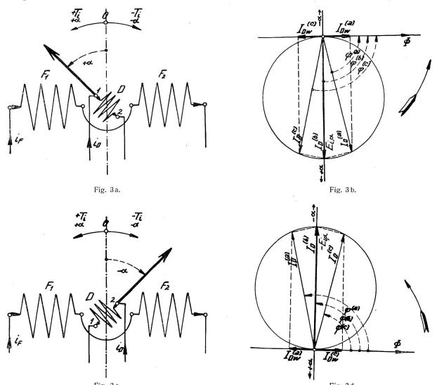
EMK  $E'_a$  aufgedrückt wird.  $E'_a$  ist je nach der vorliegenden Schaltung eine Klemmenspannung (wie im behandelten Beispiel, Fig. 2) oder der Spannungsabfall an den Enden eines stromdurchflossenen Widerstandes. Immer definieren wir mit  $\varphi'_2$  und  $\varphi'_3$  die Phasenwinkel von  $E'_a$  gegen  $E_1$ , bezw. von dem durch  $E'_a$  in der Drehspule veranlassten Strom  $I_a$  gegen  $E'_a$ .
