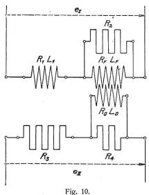
Die Feldspule werde zu diesem Zweck nach Fig. 10 über eine eisengeschlossene Drosselspule  $(R_1, \omega L_1)$  an die Spannung  $E_1$  gelegt. An der Feldwicklung liege der induktionsfreie Nebenwiderstand  $R_2$ . Die Anordnung, welche nach dem Erfinder "Hummelschaltung" genannt wird, ermöglicht bekanntlich, dem Strom im induktiven Zweig eine Phasenverschiebung von 90° oder mehr gegen die Speisespannung zu geben.
