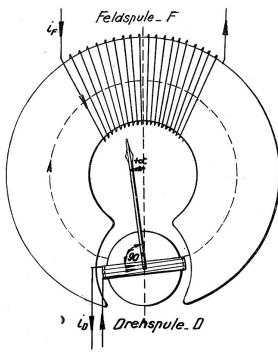
Instrument schematisch dargestellt. Fig. 2 zeigt das Schema der Schaltung, welche der nachfolgenden Betrachtung als Grundlage dient. Danach liegt die Feldspule F in Reihe mit einem induktionsfreien Vorwiderstand  $r_{\rm v}$  an einer Wechselstromquelle mit der Klemmenspannung  $e_1$ <sup>3</sup>). Eine zweite Stromquelle 4) mit der Klemmenspannung e'a
