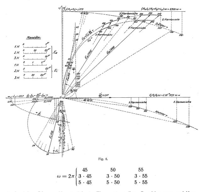
durchgeführt. Die zum Verständnis der Figur notwendigen Bezeichnungen und Massstäbe sind in jener eingetragen. Die schwache Krümmung der Kurve lässt uns für das Einzeichnen derselben in den in Betracht fallenden Zonen mit je drei Punkten auskommen. Die erforderlichen Zwischenwerte lassen sich mit genügender Genauigkeit interpolieren. Von der  $E'_a$ -Kurve gelangen wir zur  $E_a$ -Kurve durch Multiplikation mit dem komplexen variabeln Faktor  $\frac{Z_2 + Z_3}{Z_2}$ .
