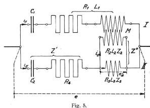
Stromzweig I wird gebildet durch die Feldwicklung in Reihe mit einem Kondensator  $C_1$  und einem Widerstand  $R_1$ , Stromzweig II durch einen Kondensator  $C_2$  in Reihe mit einem Widerstand  $R_3 + R_4$ ,  $L_3$ , den wir also zunächst als induktiv voraussetzen; parallel zu  $R_3$ ,  $L_3$  liege die Drehspule. Wir leiten wiederum die Beziehungen ab für die der Drehspule aufgedrückte Spannung  $E'_a$  und für die in jener induzierten EMK  $E_i$ .
