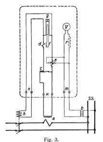
Schaltung des N-Relais (Wechselstromauslösung).
