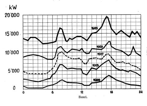
Fig. 5. Entwicklung der Leistungskurven an den höchstbelasteten Tagen für die Stadt Basel.
