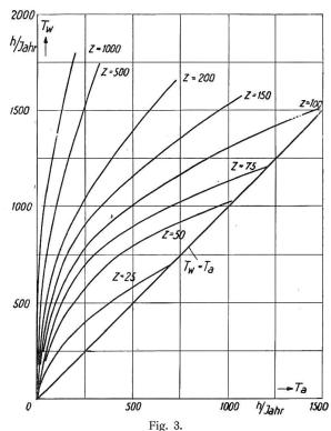
Kurven der Benützungsdauer im Elektrizitätswerk bei verschiedener Anzahl Abnehmer gleicher Leistungen und Benützungsdauer bei 8760 h/Jahr möglicher Betriebszeit.
