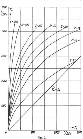
Elektrizitätswerk dann ergeben, wenn dasselbe ausschliesslich von Z gleichartigen Abnehmern, je mit  $T_a$  als Benützungsdauer, in Anspruch genommen wird. Die auf Grund der Fig. 1 gewon-
