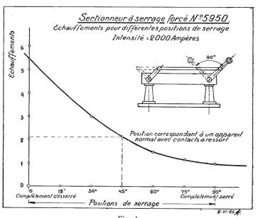
Fig. 4. Graphique d'essai d'un sectionneur.
