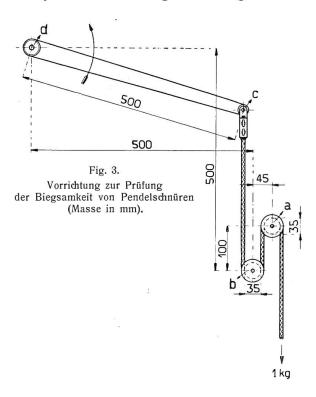
Der zu prüfende Leiter wird an einem Ende mit einem Gewicht von  $1~\rm kg$  gespannt, am andern im Punkte c an einer Zugsvorrichtung befestigt, welche aus einer Kurbelwelle d, mit dem Hebelarm dc besteht und sich mit 10 Umdrehungen pro Minute dreht. Der Leiter führt dadurch über eine Länge von 1 m mit einer maximalen Geschwindigkeit von 0,52 m/sec. eine hin- und hergehende Bewegung aus.
