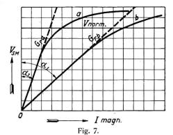
Leerlaufcharakteristiken a und b von Synchronmaschinen mit verschiedenen Reguliergeraden Gra und Grb.  $a_1$  bei langen und  $a_2$  bei kurzen Leitungen.
