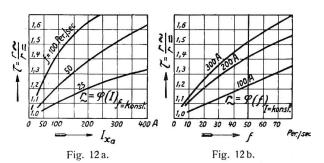
Prozentuelle Erhöhung der Resistanz bezw. der Verluste bei Wechselstrom gegenüber Gleichstrom bei verschiedenen Stromstärken und Frequenzen in einem Stahlaluminiumseil, bestehend aus 30 Aluminiumdrähten zu je 2,5 mm Durchmesser und 7 Stahldrähten zu je 2,5 mm Durchmesser. Die Stahlseele ist im "Gleichschlag" verlertigt (im "Gegenschlag" ändern sich die Verluste).
