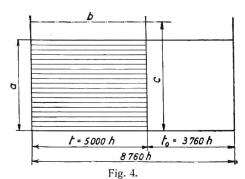
Jahresbelastungsdiagramm auf konstante Vollast,  $\cos$ - $\varphi_3$  = -0,80 und 5000 Benützungsstunden reduziert.
