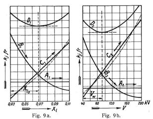
Jahresmaterialkosten + Verlustkosten in Funktion von  $A_1$  und  $A_2$  = Material- + Verlustkosten unabhängig von Xt und V.  $B_1$  und  $B_2$  = Material- + Verlustkosten abhängig von Xt und V (Leiter).  $C_1$  und  $C_2$  = Material- + Verlustkosten ebenfalls abhängig von Xt, aber in umgekehrtem Sinne.  $D_1$  und  $D_2$  = resultierende, die günstigsten Werte von Xto und  $V_W$  anzeigende Kurven.
