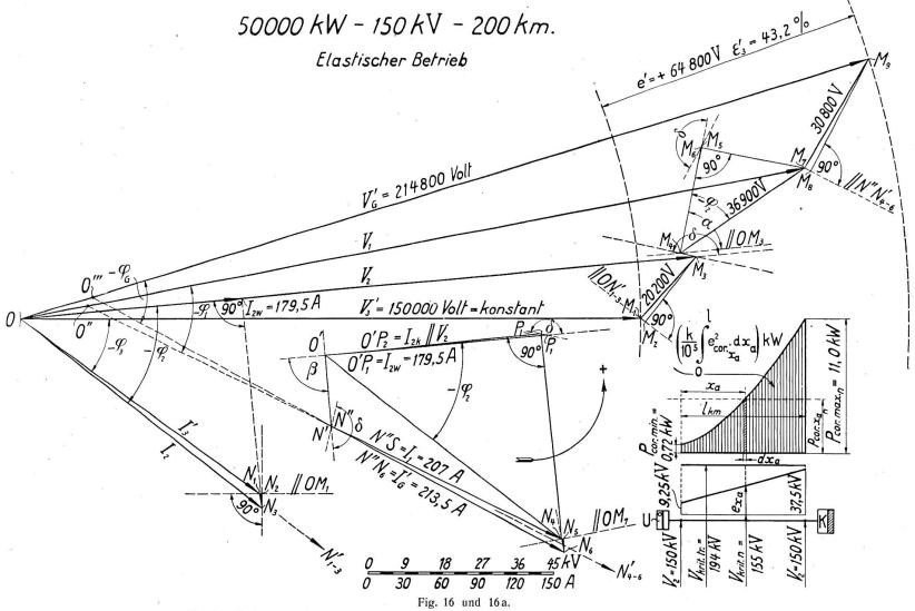
Fig. 16: Vollastvektordiagramm und Stromhiltsdiagramm der "elastischen" Fernleitung von K nach B. Fig. 16a: Verlauf der Koronaverlustkurve bei nassem, stürmischem Wetter längs der Leitung bei gleichem Aluminiumseil wie beim starren Betrieb.
