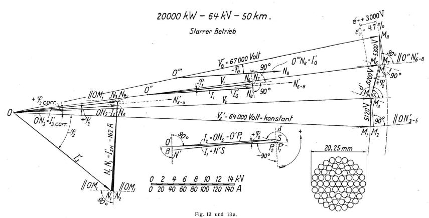
Fig. 13: Vollastvektordiagramm der "starren" Fernleitung von K nach A. Fig. 13a: Aufbau des Aluminiumseiles: 61 Drähte zu je 2,25 mm Durchmesser.
