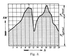
Generelles Tagesbelastungsdiagramm in den Hauptunterwerken A, B und C.
