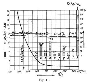
1. Kurventafel zur Bestimmung der approximativen Anlagekosten einer mittleren und grossen Drehstromkraftübertragung bei gegebenem  $P_3/I$  und  $p_kWh\ t$ , inkl. die beiden Endstationen, exkl. Kraftwerk-Unterspannungsseite und Feeder, Unterwerk-Unterspan-
