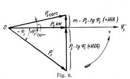
Vektordiagramm zur Bestimmung der Kompensationsleistung der Synchronmaschine (nicht masstäblich).
