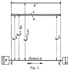
Idealer anzustrebender Spannungsverlauf längs der Fernleitung.
