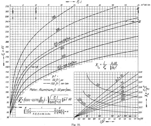
Kurventafel zur Bestimmung der wirtschaftlichen Uebertragungsspannung von mittleren und grossen Drehstromfernleitungen aus Aluminium (ohne Stahlseele) für 50 Per./sec. in Funktion von P<sub>3</sub>, I, pkWh und t.
