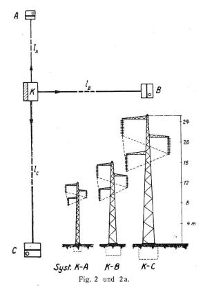
Fig. 2: Generelles Schema der drei Kraftübertragungssysteme von K nach A, B und C.
