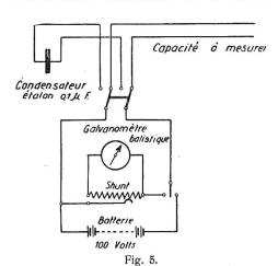
Schéma pour la mesure des capacités par la méthode de comparaison.
