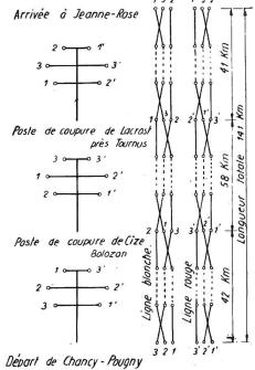
Fig. 3. Schéma de permutation des phases le long de la ligne.
