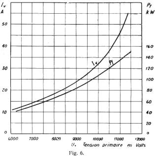
Caractéristiques à vide côté basse tension pour un groupe transformateur triphasé  $3\times4666$  kVA,  $11\,000/120\,000$  volts,  $\Delta/\gamma$ .
