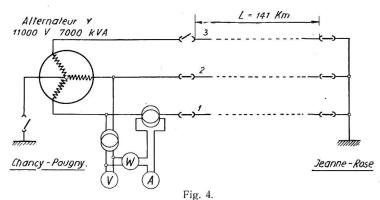
Schéma pour la mesure de la résistance et de la réactance avec du courant alternatif 11 000 V.
