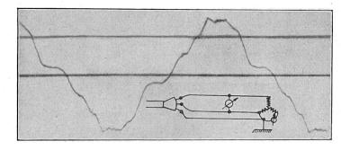
Tension d'un alternateur lors d'un court-circuit bipolaire.
