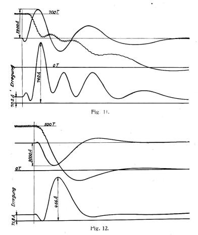
der sich schon vor Jahren an einem grossen 25 periodigen Turbogenerator ereignete, ist mir bekannt. Da die bremsenden Momente nicht nur im Rotor allein zum Ausdruck kommen, sondern eine Wechselwirkung zwischen Rotor und Stator sind, so wird auch dieser durch sie beansprucht und zwar sind es in erster Linie die Schraubenbefestigungen eventuell Gehäusetrennungen und die Fusschrauben, welche diesen Momenten am meisten ausgesetzt sind.
