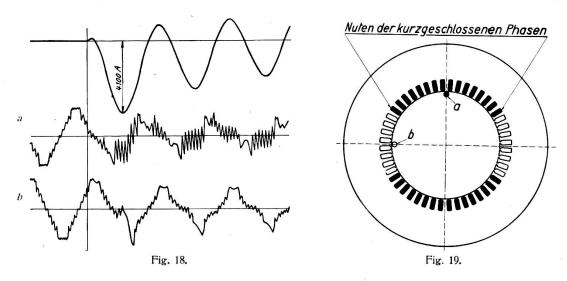
Fig. 18 gibt uns darüber Aufschluss. Darin ist unter dem Kurzschlusstrom die Kurve a das Feld senkrecht zur Achse der beiden kurzgeschlossenen Phasen (ent-
