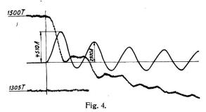
sind im gleichen Schaltmoment und bei gleicher Tourenzahl aufgenommen. Die Drehzahlabfallinie in Fig. 3 mit torsionselastischer Kupplung zwischen Generator und Tachometerdynamo zeigt deutlich die Ueberschwingungen, welche diese infolge ihrer elastischen Welle ausführte, während die Drehzahlabfallinie in Fig. 4 bedeutend schwächer ausgeprägte Pendelungen aufweist und den richtigen Drehzahlverlauf des Generators wiedergibt.
