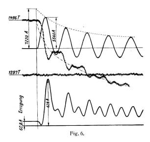
Dämpfung beeinflussten theoretischen Anfangsamplitudenwert  $\overline{J}_{kpo}$  des plötzlichen Kurzschlusstromes. Aus diesem Wert bestimmt sich die wirksame Streureaktanz zu:
