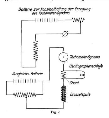
veränderung zu erhalten, wurde der Ausgleichstrom zwischen Tachometerdynamo und einer zweiten Akkumulatorenbatterie nach dem Schema Fig. 2 dazu benutzt. Durch Einstellen des Regulierwiderstandes zwischen Tachometerdynamo und Batterie konnte der Empfindlichkeitsgrad beliebig gewählt werden.
