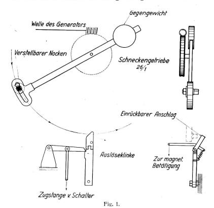
war folgendes: Der Kurzschluss erfolgte durch einen Oelschalter, der durch Gewicht betätigt wurde, und zwar war das Gewicht sehr gross, so dass dieses Moment die Reibungsmomente des Schaltmechanismus um ein Vielfaches überstieg. Dadurch konnte man für alle Fälle mit genau gleicher Schliesszeit für den Schalter rechnen.
