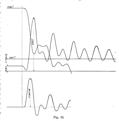
den Bremskraft ausgesetzt, der entsprechend dem Trägheitsmoment auf den Rotor der Antriebsmaschine entfällt, dazu tritt aber noch die konstante Beanspruchung, die von der jeweiligen normalen Belastung herrührt.
