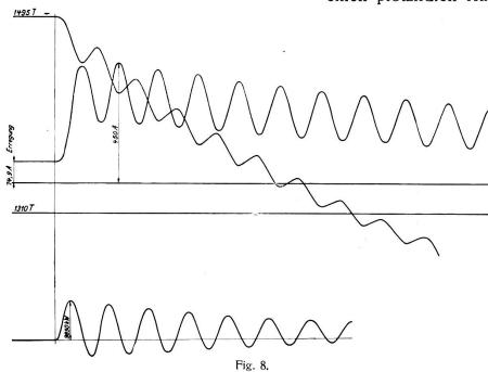
Erregung und 1500 Umdrehungen pro Minute im günstigsten Moment, nämlich dann, wenn die Spannungswellegerade ihr Maximum erreicht hat. Der Verlauf des Kurzschlusstromes symmetrisch zur Nullinie. Der Erregerstrom zeigt ebenfalls ein starkes Ansteigen auf den mehrfachen Wert und im überlagerten Wechselstrom bekannte doppelte Frequenz. Genau phasengleich
