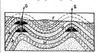
Fig. 1. O = Oel. W = Wasser. G = Gas. F = Oberfläche.
