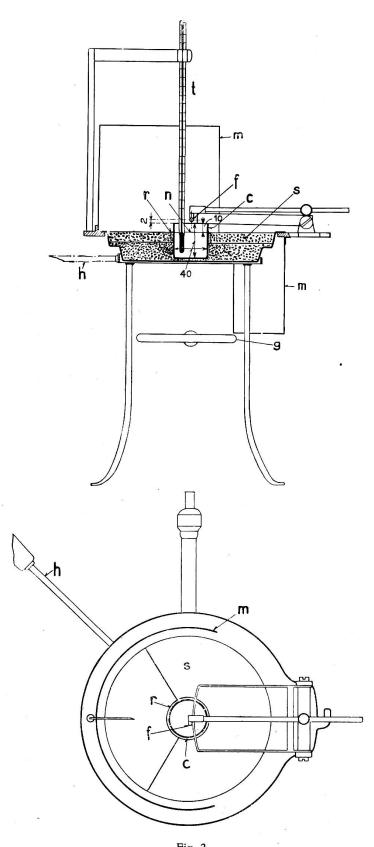
Fig. 2. Marcussonapparat zur Bestimmung des Flammpunktes.
