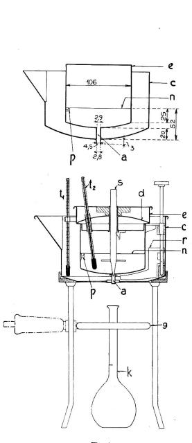
Fig. 1. Das Englersche Viskosimeter.
