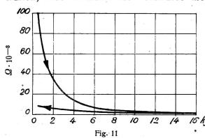
Uebergangswiderstand eines eingeschliffenen Kupfer-Flächenkontaktes in Funktion des Druckes, nachdem derselbe während 5 Minuten auf 100°C gehalten wurde.
