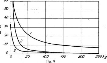
Uebergangswiderstand von Kupferkontakten in Funktion des Druckes. Kurve 1: Punktkontakt, Kurve 2: Flächenkontakt, Kurve 3: gerauhter Flächenkontakt.
