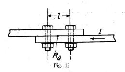
so ist es zweckmässig, die Kontaktflächen mit einer schwer oxydierbaren Materialschicht zu überziehen, sei es durch Verzinnen, Vernickeln oder Versilbern. Dies wird direkt zur Notwendigkeit, wenn der Kontakt von aussen erwärmt wird, wie es bei Klemmen an Heizkörpern vorkommen kann.
