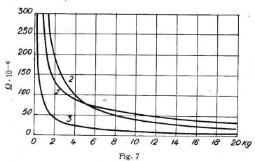
Uebergangswiderstand von Kupferkontakten in Funktion des Druckes. Kurve 1: Punktkontakt, Kurve 2: Flächenkontakt, Kurve 3: gerauhter Flächenkontakt.
