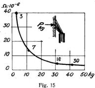
Um sich ein Bild von der Grössenordnung des Uebergangswiderstandes eines Bürstenkontaktes machen zu können, führen wir in Fig. 15 einige Werte an. Es handelt sich hier um einen Kontakt von vier parallelen Bürsten.
