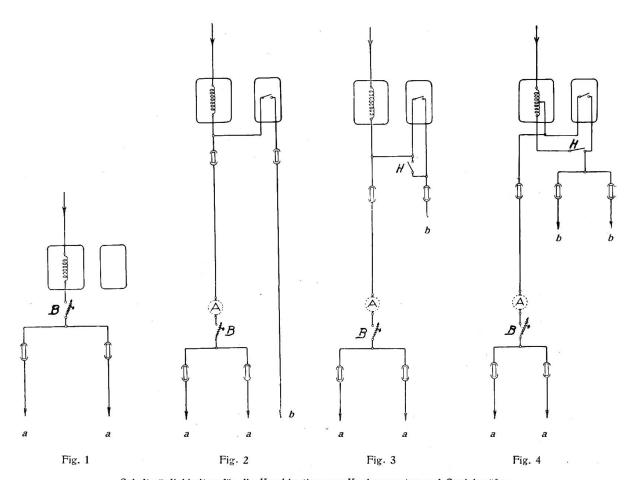
Schaltmöglichkeiten für die Kombination von Kochapparaten und Speicheröfen.  $H = \text{Handschalter}, \ B = \text{Strombegrenzer} \ \text{mit Handeinschaltung}, \ a = \text{Koch- und Speicherofen}, \ b = \text{Warmwasserspeicher}.$
