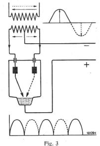
verbunden wird, da eine Strömung von Elektronen, d. h. kleinster negativer Teilchen, unter dem Einflusse einer Potentialdifferenz nur vom negativen gegen den positiven Pol hin erfolgen kann. Auf dieser Tatsache beruht die Ventilwirkung des Gleichrichters.
