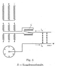
die leichtfüssig von Anode zu Anode springt und die Scheitelwerte der Stromkurven der einzelnen Phasen auf der Gleichstromseite aneinanderreiht.
