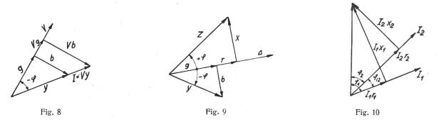
Regeln der Addition und Subtraktion der Vektoren, auch auf Impedanz- und Admitanzvektoren anwendbar sind. Hingegen ist die Multiplikation weder skalar noch vektoriell auszuführen.
