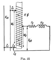
Nun setzt man voraus: der gemeinsame Fluss  $(k \Phi)$  soll bei Variation des Windungszahlverhältnisses konstant bleiben. Es sei  $W_2$  konstant und  $W_1$  variabel. Aendert man den Belastungskreis nicht, so bleibt, da  $V_{2k}$  konstant ist,  $I_2$  ebenfalls konstant. Die Klemmenspannung  $V_{1k}$  wird mit der Variation der Windungszahl  $W_1$  derart
