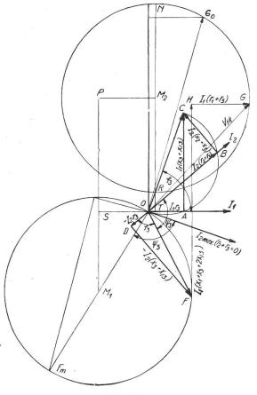
oder graphisch ermitteln. Da die graphische Methode übersichtlicher und einfacher ist, suchen wir auf diesem Wege den geometrischen Ort der Impedanz z. Für  $(r_2 + r_3) = 0$  kommt der Punkt B nach O zu liegen,  $I_2$  wird ein Maximum, und somit ist der Durchmesser  $\overline{OF_m}$  des Kreises mit  $M_1$  als Mittelpunkt bekannt.
