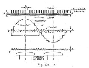
den Nutenkeilen hochfrequente Wirbelströme hervorrufen, so versteht man, dass sie häufig zu starker Verlustbildung und erheblicher Erwärmung Anlass geben.
