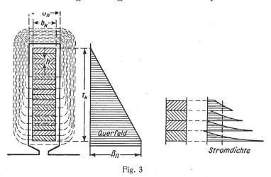
dabei Wirbelströme, die sich den Normalströmen überlagern. Je nach ihrer Richtung addieren oder subtrahieren sich die Wirbelströme zum Betriebsstrom und erzeugen daher eine Stromverdrängung in allen einzelnen Nutenleitern nach dem Aussenrand der Nute zu. Nach innen kann unter Umständen Gegenstrom entstehen. Da die Elementarverluste in jeder Raumeinheit der Leiter quadratisch mit der Stromdichte wachsen, so entstehen durch das Querfeld zusätzliche Verluste, die mit dem Qua-
