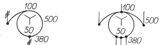
Régulateurs d'induction (Autotransformateurs à bobine tournable).
