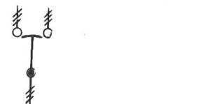
274. Commutateur (interrupteur à plusieurs positions) à main, sans rupture, à 2 directions, à 1 pôle
