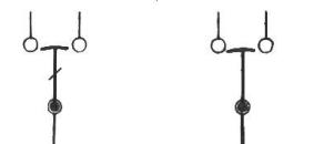
275. Commutateur (interrupteur à plusieurs positions) à main, sans rupture, à 2 directions, à 3 pôles
