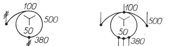
Régulateurs d'induction (Autotransformateurs à bobine tournable).
