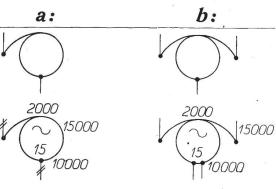
Autotransformateur, monophasé, p. ex. 15 pér., 2000 kVA, 10000/15000 V 306. Spartransformator, einphasia, z. B. 15 Per., 2000 kVA, 10 000/15 000 V
