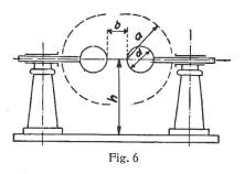
Der Durchmesser der Schenkel, welche die Kugeln tragen, darf nicht grösser als  $^{1}/_{5}$  des Kugeldurchmessers sein. Metallbänder und Ver-
