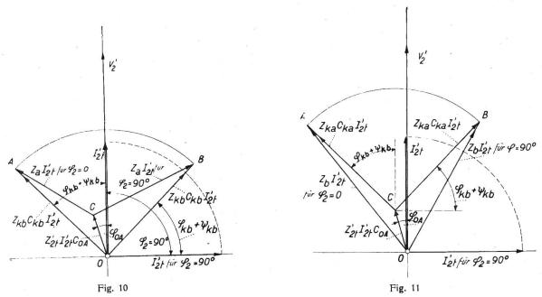
Wir bezeichnen wiederum den Betrag dieser geometrischen Summe mit  $Z_{\mathfrak{b}}$ und da beide Vektoren miteinander den Winkel  $\varphi_{ka} + \psi_{ka} - (\varphi_{0A} + \varphi_2)$  einschliessen, so wird daher der Zähler der zweiten Gleichung (30)
