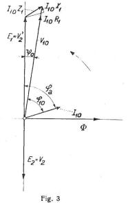
Wird der Transformator primärseitig an eine Spannung V<sub>10</sub> gelegt, so können wir durch eine Leistungsmessung die von demselben aufgenommene Leistung messen und mittels des gemessenen Leerlaufstromes I<sub>10</sub> die primäre Leerlauf-Phasenverschiebung bestimmen.
