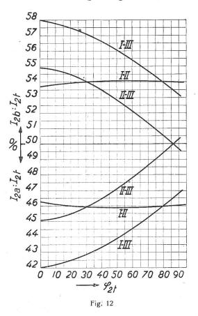
Zum Schlusse betrachten wir noch die Parallelschaltung der Transformatoren II und III. Beide Transformatoren besitzen gleiche Kurzschlusspannungen, jedoch ist der eine mit Zylinderwicklung und der andere mit Scheibenwicklung ausgeführt und sind verschiedenen Fabrikates.
