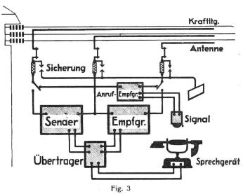
auf zu der Grössenordnung 500 000 pro sec. entspricht. Auf der Leitung überlagern sich die beiden Wechselströme, aber am Empfangsort wird nur derjenige Wechselstrom, nämlich der Sprechstrom, aufgenommen, auf welchen die Empfangsapparatur abgestimmt ist.
