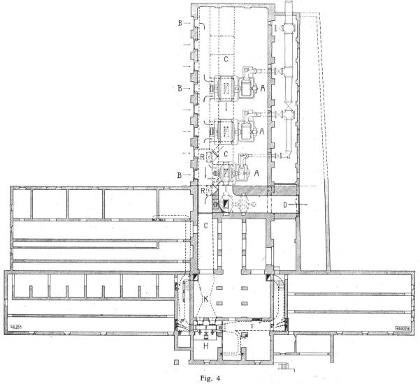
Legende: A Generatoren; B Frischlufteintritte; C Warmluftsammelkanal; D Warmluftaustritt ins Freie; H Ventilatoren; I Warmluftverteilkanal; K Messtelle; R Luftklappen.
