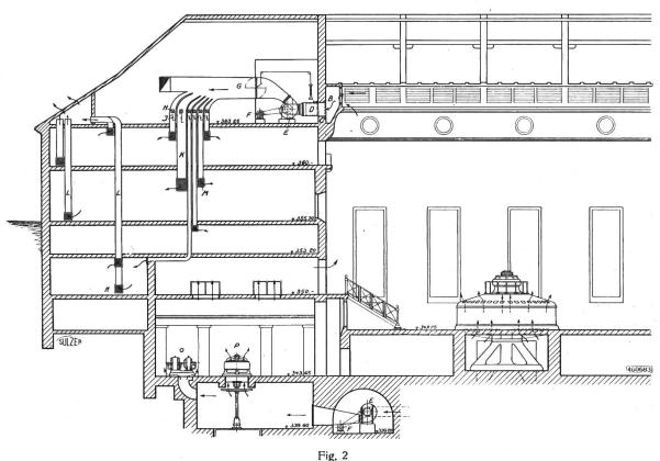
A Warmlufteintritt vom Maschinensaal; B Warmluftkanal; C Frischlufteintritt von aussen; D Umstell-klappe; E Ventilator; F Motor; G Hauptabschlussklappe; H Kontrolldeckel; J Regulierklappen; K Warmluftkanäle zu den Räumen; L Abluftkanäle; M Warmluftgitter; N Abluftgitter; O Erregergruppe; P Generator für Eigenbedarf.
