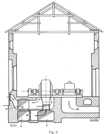
Unter Abzug des Wärmebedarfes des Maschinenhauses wird eine erhebliche Wärmemenge zu Heizungs- und eventuell anderen Zwecken zur Verfügung bleiben.
