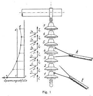
Spannungskurve und Prüfung eines Hängeisolators.
