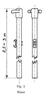
Leitungen mit Hilfe der früher erwähnten Schlüssel und der spitzigen Haken, womit Keile und Stifte herausgezogen werden. Es ist nunmehr noch zu zeigen, wie das Wegstossen des Leitungsdrahtes vorsichgeht. Bei kleinen Spannweiten und geringen Leitungsquerschnitten genügen hierzu zwei Klauen oder eine Klaue und ein "Kitzel-
