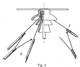
Prüfung eines Stützisolators.
