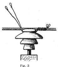
Aufbinden des Leitungsdrahtes.
