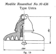
métallique. La tige n'est pas filetée, mais droite, et les fabricants se sont ingéniés à éviter tout effort excessif du ciment ou des ferrures sur la porcelaine. L'emploi de couche élastique sous forme d'enduit, laque ou paraffine, réduit la résistance mécanique de l'isolateur monté, mais permet encore d'atteindre 2500 kg pour l'isolateur suspendu courant et 3000 kg pour celui d'amarrage.
