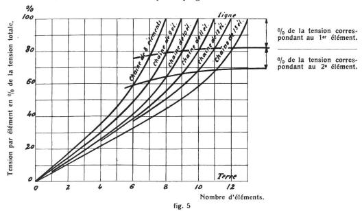
dont le premier élément supporte toujours environ 30% de la tension totale; les chiffres les plus bas s'appliquent aux chaînes d'isolateurs Ohio-Brass. Les isolateurs Jeffery-Dewitt ne se comportent pas mieux que les isolateurs Hewlett au point de vue de la répartition de la tension entre éléments comme le montrent les résultats du tableau ci-dessous tiré du Journal of A. I. E. E. de juillet 1920.
