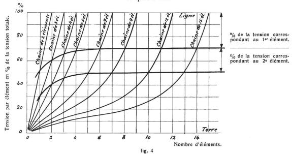
Répartition de la tension entre les éléments de chaînes formées d'isolateurs Ohio-Brass. D'après Ljungdahl.
