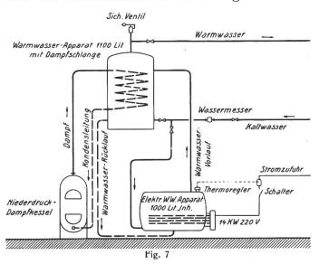
Schematische Darstellung der Versuchsanlage No. 3.
