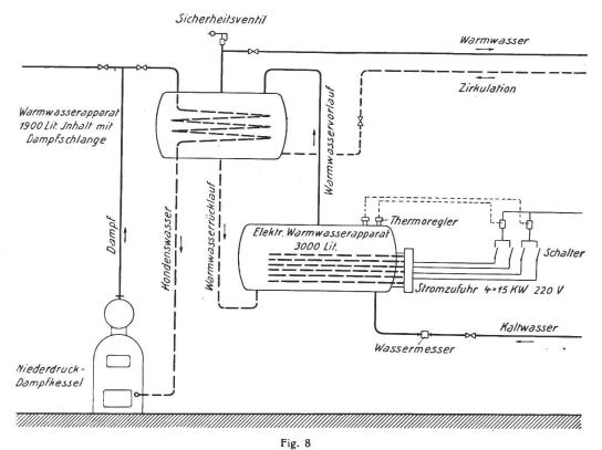
Schematische Darstellung der Versuchsanlage No. 4.
