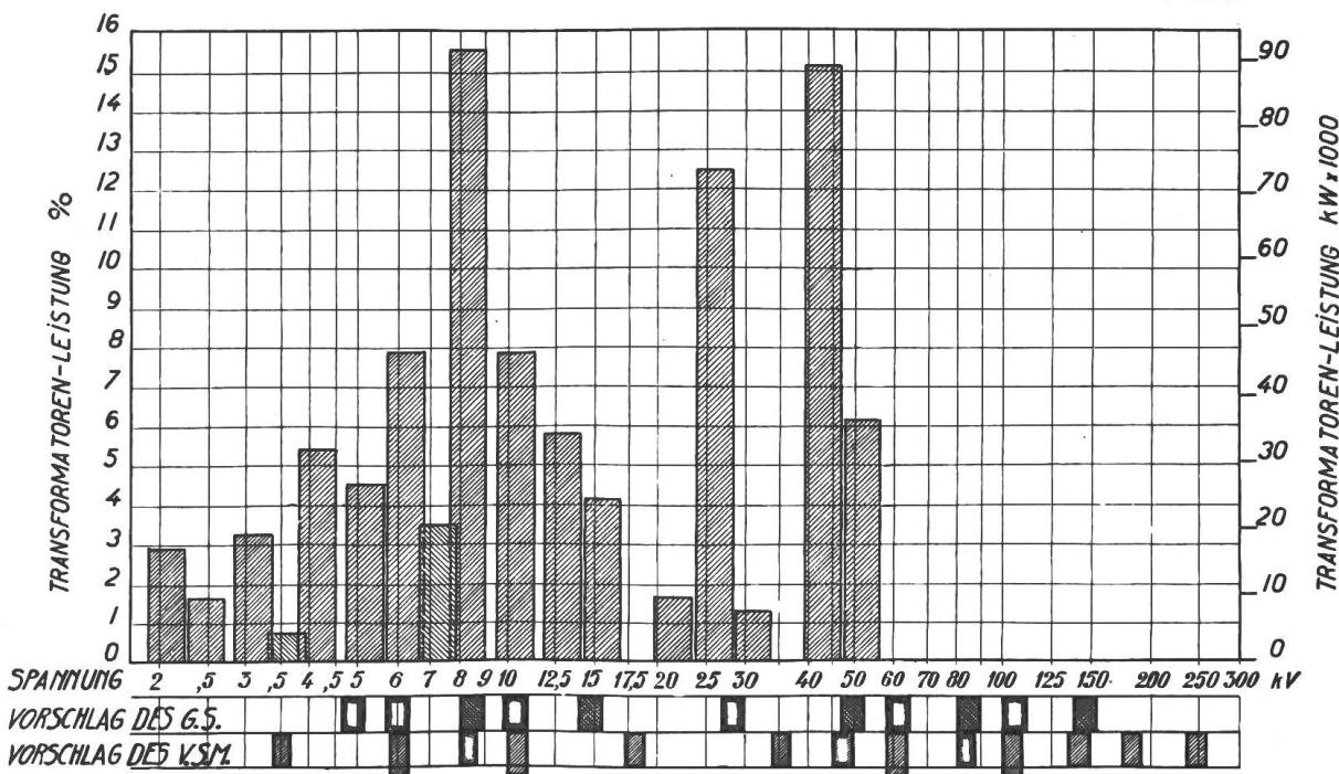
wurde jedoch später auch die Spannung 40 : 50 kV eingeführt und ist jetzt ein Umbauprozess im Gange, bei welchem die Anlagen mit 25 kV sukzessive in solche von 40 bis 50 kV umgeändert werden. Diese Werke, die zusammen die grösste Investition in 25 kV besitzen, erklärten ausdrücklich, dass diese Spannung bei ihnen nun nach und nach verschwinden werde. Bringt man deren Anteil an dieser Spannung in
