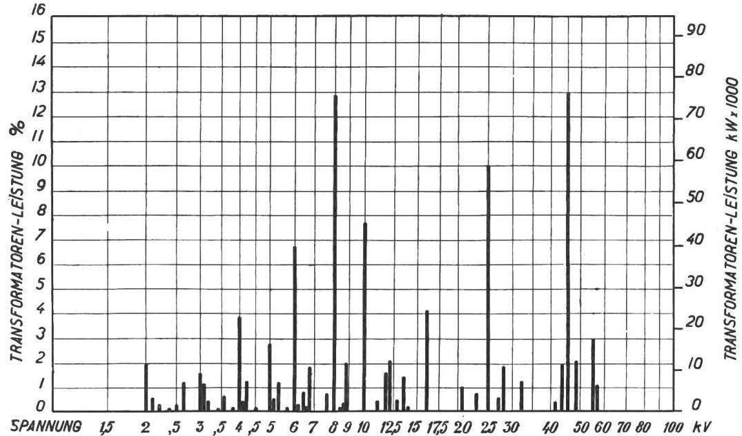
Leistungen der Unterwerks- und Ortstransformatoren gruppenweise zusammengefasst (- 5% bis + 12%) geordnet nach Primärspannungen und Vorschläge zur Vereinheitlichung der Hochspannungen.
