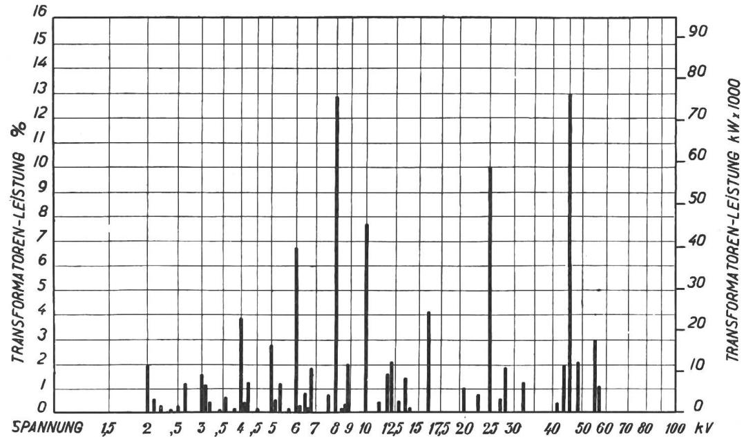
Leistungen der Unterwerks- und Ortstransformatoren gruppenweise zusammengefasst (- 5  $\div$  + 12%) geordnet nach Primärspannungen und Vorschläge zur Vereinheitlichung der Hochspannungen.
