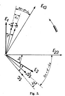
$\delta_1$  und  $\delta_2$ , diejenigen der Spannungswandler mit  $\varepsilon_1$  und  $\varepsilon_2$ . Gemäss der üblichen Bezeichnung soll ein Fehlwinkel positiv sein, wenn der umgeklappte sekundäre Vektor dem ent-
