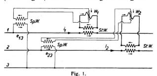
Sp. W = Spannungswandler, St. W. = Stromwandler, W<sub>1</sub>, W<sub>2</sub> = Wattmeter, resp. die beiden Systeme eines Drehstrom-Dreileiter-Zählers.
