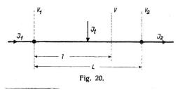
Ist also die Stromverteilung im Geleisenetz bekannt, so können die Schienenpotentiale im ganzen Netz nach den Formeln (10) und (10a) berechnet werden. Es könnte dabei ganz willkürlich irgend einem Punkte das Potential Null gegeben werden; um jedoch einen leichten und übersichtlichen Vergleich mit dem Plane der Spannungsmessungen zwischen Schiene und Rohr
