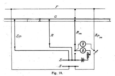
Schaltungsschema zur Messung des Widerstandes von Schienenspeisekabel.
