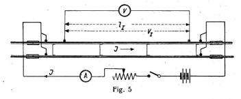
bei Annahme eines in beiden Schienen des Geleises gleichen Schienenwiderstandes pro Längeneinheit, diesen Widerstand nach folgender Formel berechnen:
