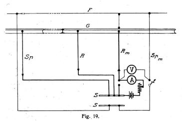
Schaltungsschema zur Messung des Widerstandes von Schienenspeisekabel.
