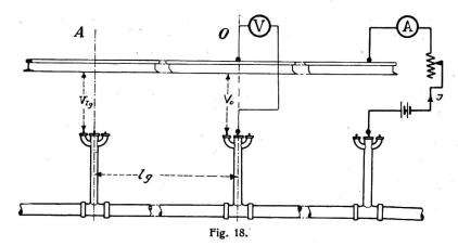
hat das Bureau of Standards Washington angestellt 1) über deren Ergebnisse wir noch berichten werden. Wir haben versucht, diesen Widerstand auf folgende Art zu bestimmen: 2) Eine Batterie wird über einen Widerstand und ein Amperemeter zwischen Schienen und Rohrleitungen geschaltet und Spannungen zwischen Schienen und Rohr an einem benachbarten Hydranten und einem weiteren, einige hundert
